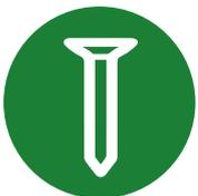
**Pontas afuniladas e aguçadas** penetram facilmente nas fibras da madeira e todas as fibras pressionam essas pontas, maximizando a capacidade de fixação, mas elas têm mais probabilidade de rachar a madeira. As pontas rombudas esmagam as fibras, o que reduz as rachaduras, mas também o número de fibras que as pressionam. Uma ponta piramidal pode ser um bom meio termo.
