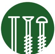
**Cabeças achatadas** reforçam a capacidade de fixação do prego e facilitam a martelagem. Os pregos sem cabeça e os balmázios (pregos de cabeça convexa) podem entrar completamente na madeira e ser cobertos para melhorar a estética.
